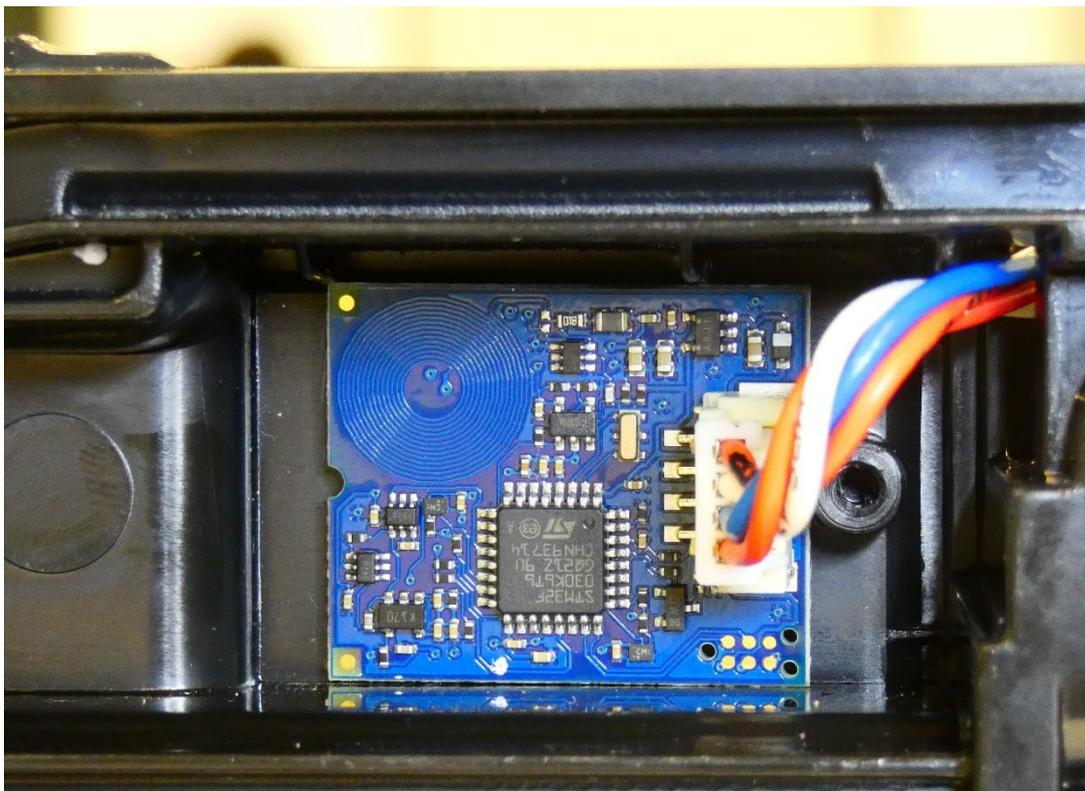
Bildtext: Kombisensor mit automatischer Luftspaltkompensation zur berührungslosen Füllstandmessung an nicht leitenden Tanks
